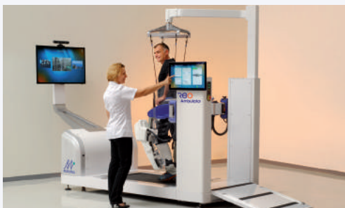
REOAMBULATOR Das Badresort Darkov ist das einzige Unternehmen in Tschechien, das den Spitzenroboter „Reoambulator“ besitzt – einen Antigravitationsgangsimulator, der ein intensives Training für Patienten mit neurologischen Beschwerden ermöglicht.
